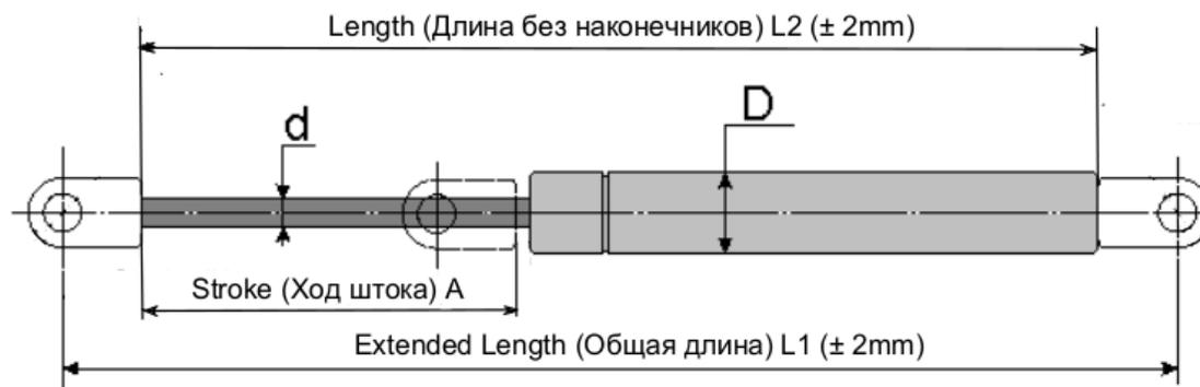
Пример заказа газовых пружин Sprinfors из нержавеющей стали AISI 304 (V2A) N
